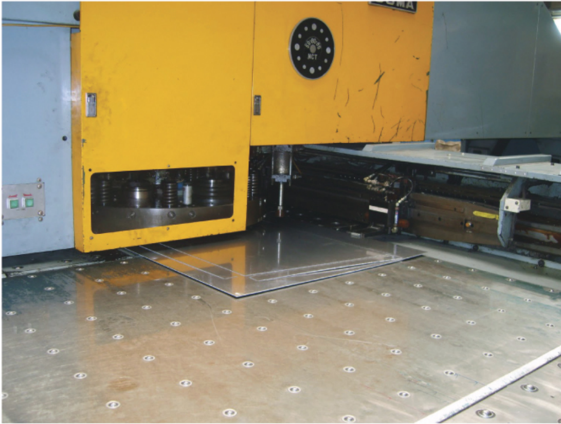
BIM가상시공 모델에 의한 아노다이징 패널제작(CNC가공)
